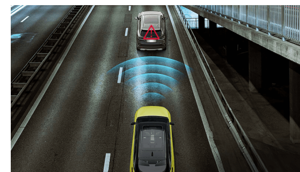
System ostrzegający przed kolizją czołową LCW oraz system automatycznego hamowania awaryjnego AEB
